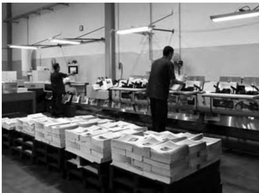
A moderna grampeadeira forma cadernos e encapa os impressos com o triplo de velocidade
